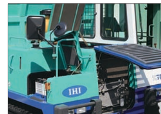
エンジン、バッテリー、オープングリル
